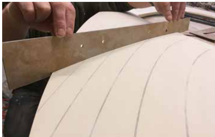
Überprüfung der korrekten Krümmung der Reflektorunterseiten. Foto: Wojtek Radwański
