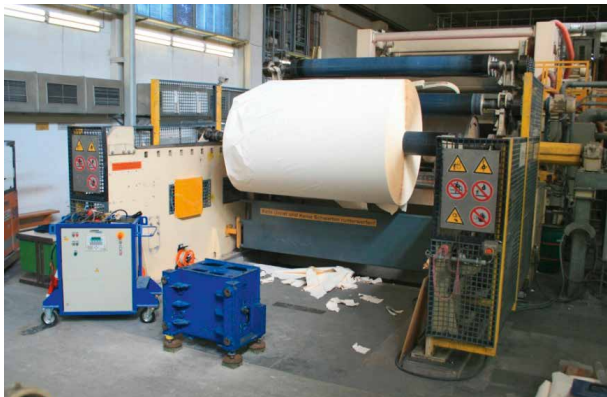
Dynamische Anregung des Fundamentrahmens einer Papiermaschine
