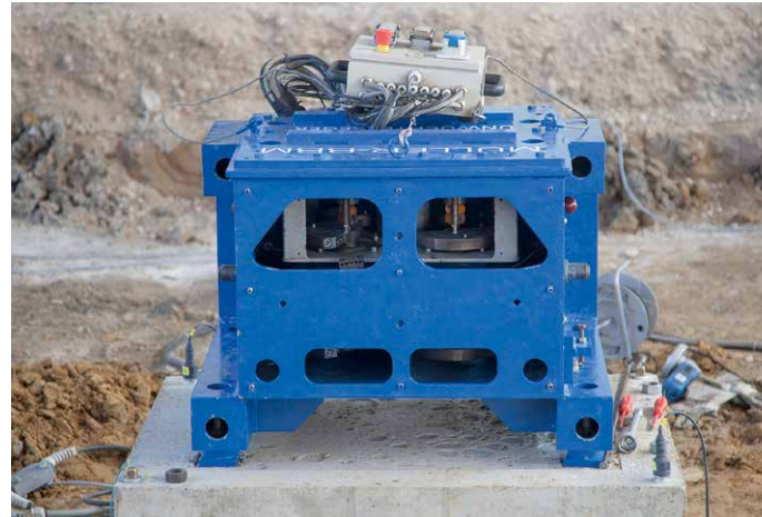
Dynamische Anregung eines Betonfundamentes zur Bestimmung der Wellenausbreitung im Boden
