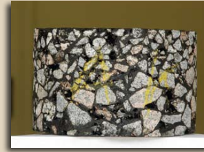
Aufbau eines zweischichtigen offenporigen Asphalts
