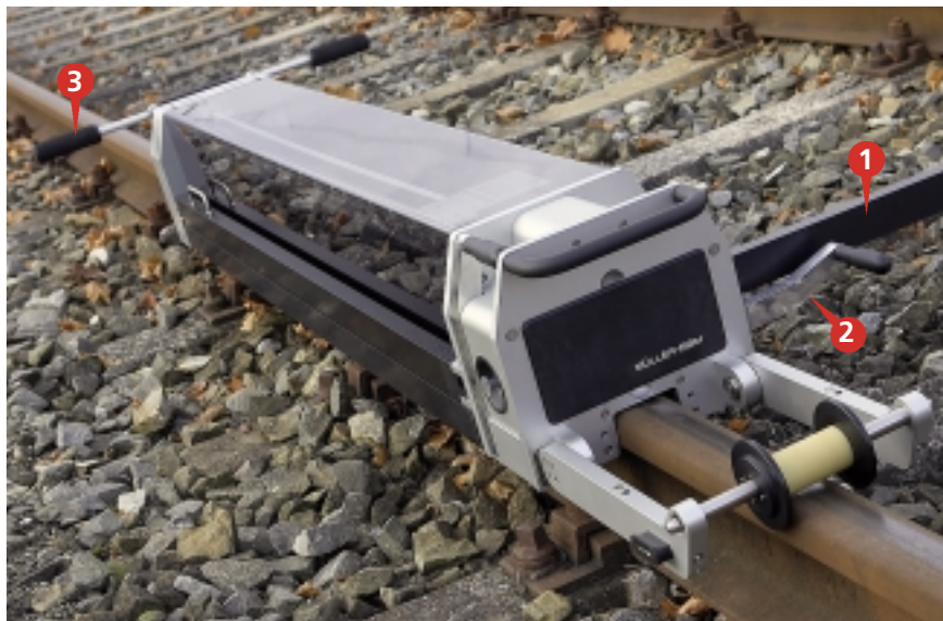
Gerät auf der Schiene, rechte Stütze ausgeklappt (1), Klemmhebel in aktiver Position (2), Tragegriffe ausgeklappt (3)
