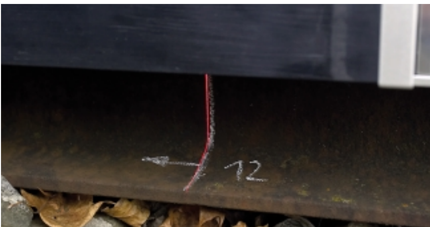
Lasermarkierung an einem Messquerschnitt
